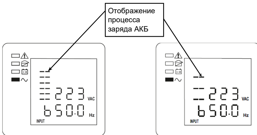
Рисунок 21 — ЖК-дисплей: форсированный (ускоренный) заряд АКБ
